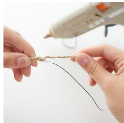
Déposez quelques gouttes de colle thermofusible sur deux morceaux de fil de bobinage et entortillez ceux-ci aussitôt d'un fil de jute.
